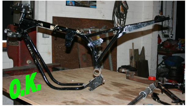
Zündapp CS25 Rahmen (original mit Unterzug)
