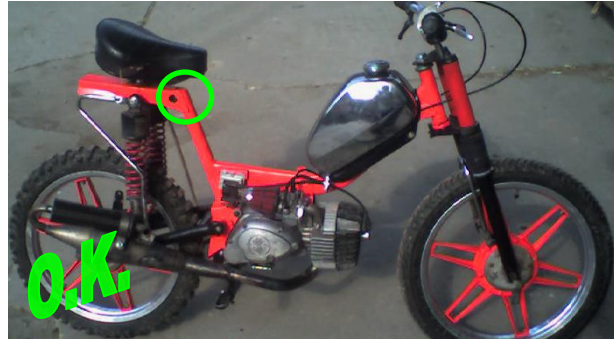
Kreidler MF23 Mofa+Rahmen (alles original außer Sattelbereich Flacheisen entfernt)
