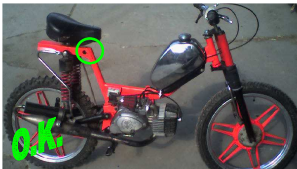
Kreidler MF23 Mofa+Rahmen (alles original außer Sattelbereich Flacheisen entfernt)
