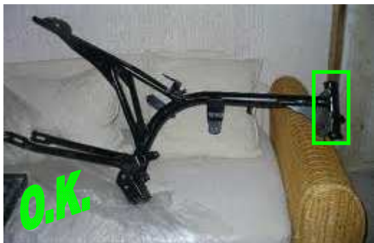
Zündapp CS25 Rahmen (original Bild ohne Unterzug) Grüner Bereich (Lenkkopfrohr) darf getauscht werden
