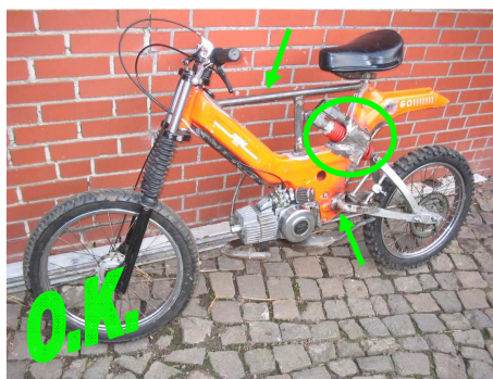
Puch (nach Reglement) Rahmen wurde im grünen Bereich durchbrochen und Flachmaterial (Halbzeug) aufgeschweißt. Zur Verstärkung wurden Rohrstreben (Halbzeug) angebaut. Schwinge wurde in original Aufnahme (gleiche Drehachse) verbaut
