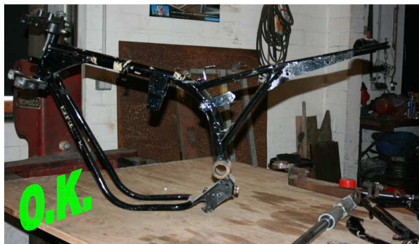
Zündapp CS25 Rahmen (original mit Unterzug)
