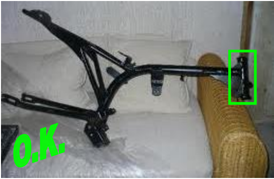
Zündapp CS25 Rahmen (original Bild ohne Unterzug) Grüner Bereich (Lenkkopfrohr) darf getauscht werden
