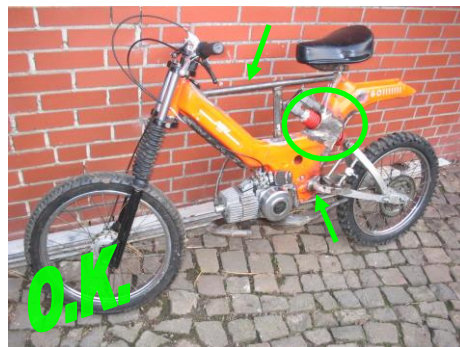
Puch (nach Reglement) Rahmen wurde im grünen Bereich durchbrochen und Flachmaterial (Halbzeug) aufgeschweißt. Zur Verstärkung wurden Rohrstreben (Halbzeug) angebaut. Schwinge wurde in original Aufnahme (gleiche Drehachse) verbaut
